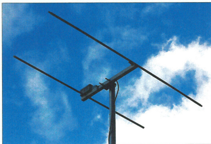
Bild 1: Die fertige 2-Element-Yagi-Antenne, lässt sich für horizontale Polarisation bequem waagrecht am Metallportabelmast befestigen. Bei vertikaler Polarisation ist die um 90^\circ gedrehte Antenne an einem Ausleger zu montieren.
