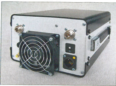
Bild 3: An der Rückseite befinden sich außer N-Buchsen und Lüfter auch der powerCON-Einbaustecker mit Flansch (r.) und über ihm der rückstellbare Überstromschutzschalter.
