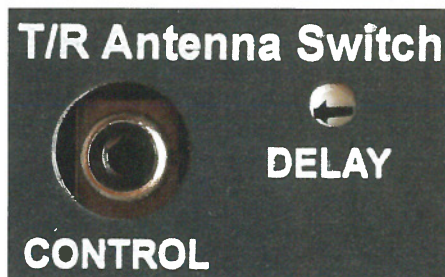
Bild 2: Für die Rückschaltung von der Sende- auf die Empfangsantenne lässt sich eine Verzögerung (Delay) einstellen.
