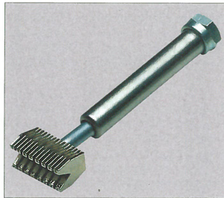
Bild 17: Mithilfe einer solchen Auslötspitze für ICs im DIL-Gehäuse lassen sich sämtliche Anschlüsse des Schaltkreises gleichzeitig erwärmen.
