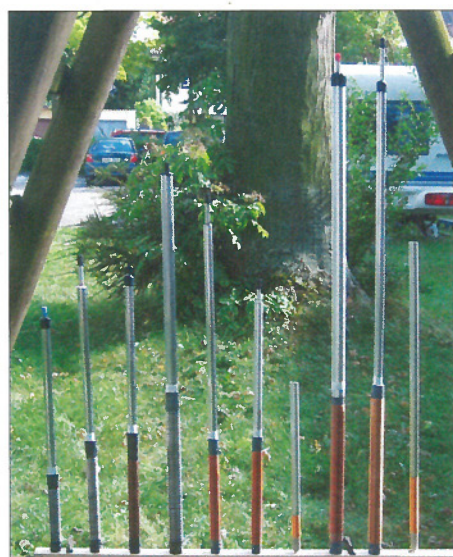
Bild 1: Bisher gebaute Muster der Mini-Mob-Antenne; links die Ausführungen für 10 m bis 17 m, rechts drei Varianten für 40 m und in der Mitte vier 20-m-Versuchsmuster
