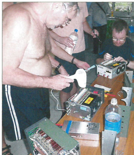
Der Feuchtigkeit zollten wir unseren Tribut – es mussten sämtliche Transistorendstufen getrocknet und gewartet werden.
