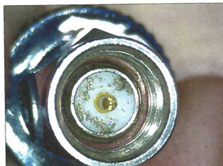
Bild 1: Bei häufigem Verschrauben bildet sich Metallabrieb an SMA-Steckverbindern.
