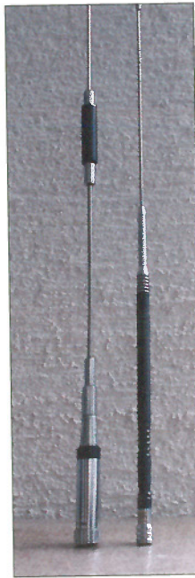
Bild 8: Beide Antennen (links Diamond NR-7900 und rechts Maldol HFC-20L) sind zwischen 1,50 m und 1,60 m lang. Aber nur die rechte längere sollte man auf einen Magnetfuß setzen; ihr starres Unterteil ist recht kurz.
