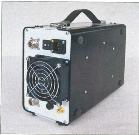
Bild 4: Dank der an einer Seitenwand angebrachten Gummifüße lässt sich die PA auch hochkant aufstellen; ferner sichtbar ist die Cinch-Buchse für PTT. Fotos: DG5VL
