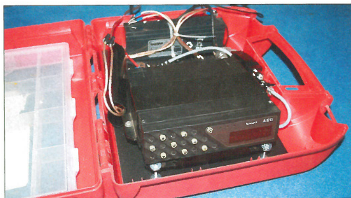
Bild 1: Der APRS-Sender besteht aus AEG Telecar 9-160, Opentracker samt GPS-Modul und Akkumulator.
